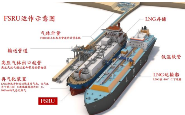
图 11: 浮式储存和再气化装置 (FSRU) 运作示意图
